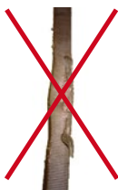
Zurrgurt unbrauchbar / Lashing strap unsuitable
