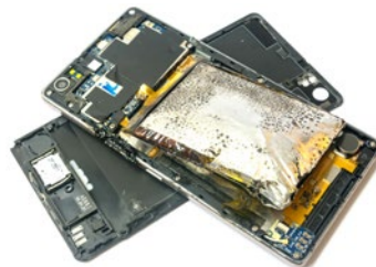
Smartphone mit aufgeblähter Pouchzelle
