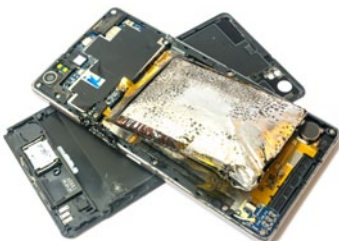
Smartphone mit aufgeblähter Pouchzelle
