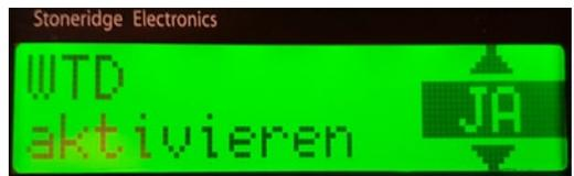
Danach kann dann die Überwachung der Maximalwerte jeweils aktiviert werden. Somit warnt der Stoneridge den Fahrer bei Erreichen der maximal zulässigen Arbeitszeit pro Woche.
