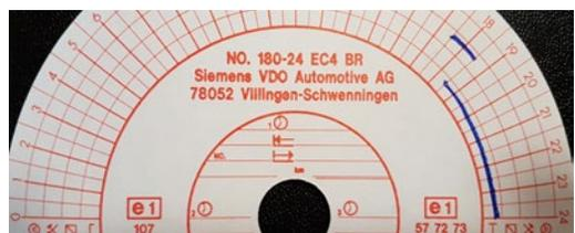
Die Vorderseite dieser Tachoscheibe muss gemäß Artikel 34 der EU-Tacho-Verordnung vollständig ausgefüllt werden. Demnach kann hier nur das Kennzeichen und der km-Stand des **aktuellen** Fahrzeugs eingetragen werden.
