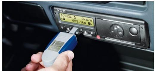
bis hin zum Remote-Download per WLAN oder Mobilfunk (GPRS etc.) mit integrierter Software für die Auswertung inkl. Integration in das Flottenmanagement.
