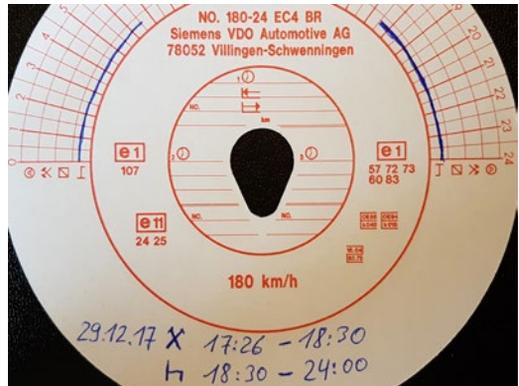
**2. Die Zeit von der letzten Entnahme** der Fahrerkarte bis 24 Uhr wird auf der Rückseite einer **separaten Tachoscheibe** nachgetragen.
