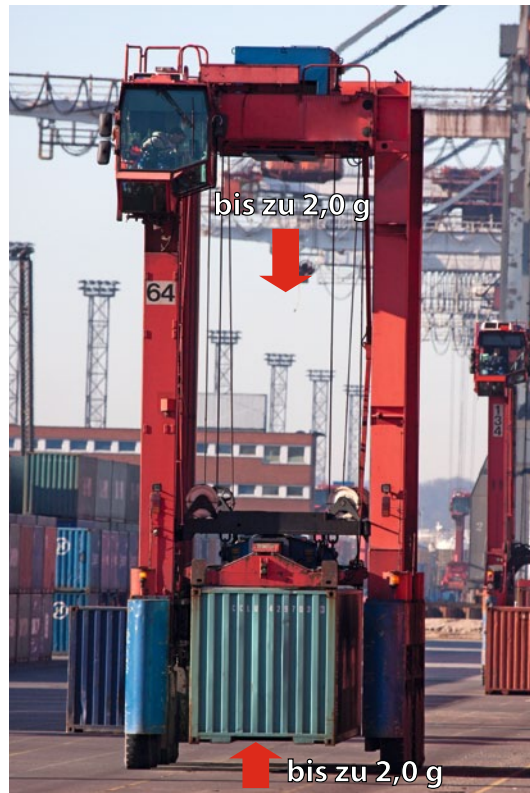
■ Abb. 3 Belastung beim Umschlag mit Van- oder Straddle Carrier
