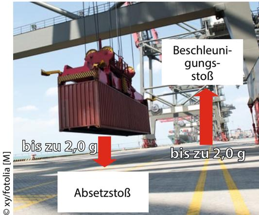
Abb. 1 Belastung beim Umschlag mit dem Portalkran
