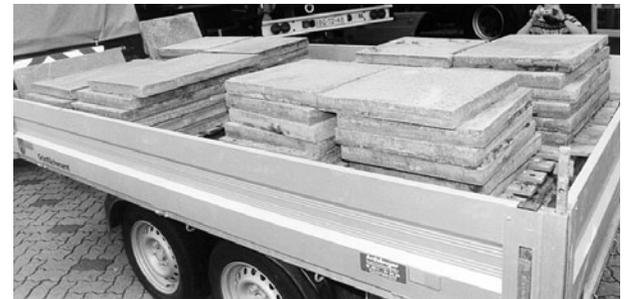
*Der gesunde Menschenverstand des Fahrers dieser Ladung (zudem gleichzeitig Halter) reichte gerade soweit, dass er zum Einen an der Stirn zwei Platten hochkant stellte, in der Hoffnung, sie würden eine Sicherung bewirken, und zum Anderen für eine (erfolglose) Ausrede gegenüber den Kontrolleuren: „Das ist eine geordnete Schüttung. Das darf man so fahren.“*
