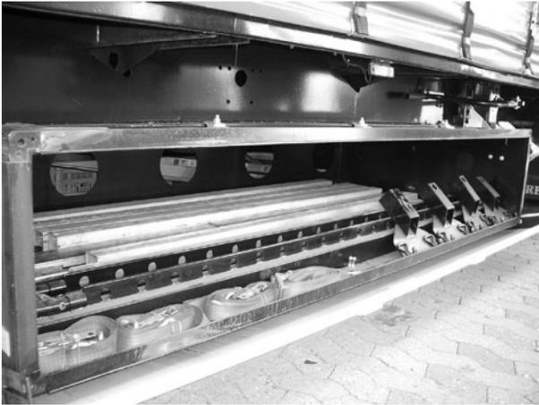
Gurte, Einsteckungen und Hilfsmittel zur formschlüssigen Fixierung von Ladung auf der Ladefläche. Mit solcher Ausrüstung kann der Fahrzeugführer auch schwere Ladungen ausreichend und in angemessener Zeit sichern. Der Schönheitsfehler: Der Verlust an Stauraum (z. B. für Paletten) und Nutzlast ist merklich.
