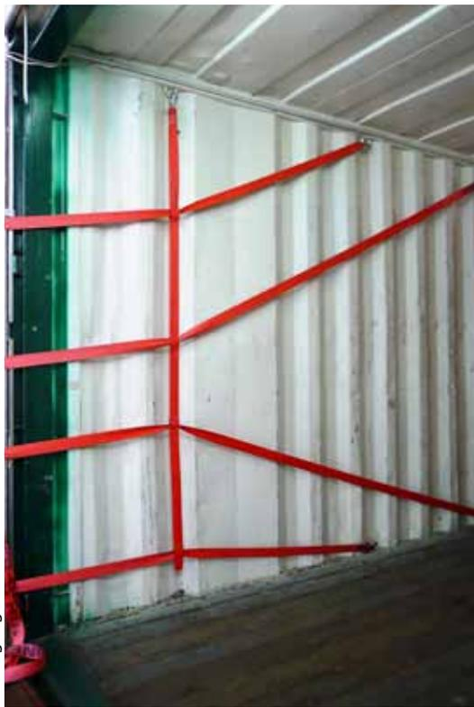
Abb. 14 Fertig installierte Lashing-Systeme
