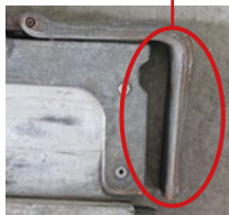
Fehlen von Gummischuh und -backe
