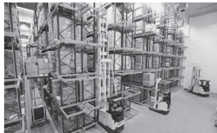
Abb. 8: Schmalgangsysteme mit Mehrplatzregalen (Foto: Jungheinrich)
