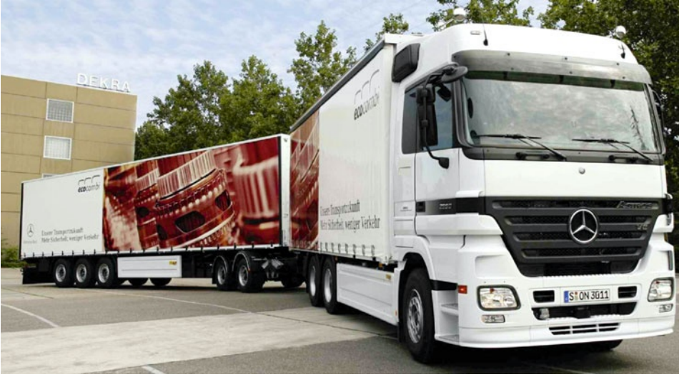
Abb. 1.31 Modellversuch 2006: Eco-Combi von Mercedes-Benz mit acht Achsen, 60t Gesamtgewicht und 25,25 m Länge. Mercedes-Benz Actros mit 440-kW(598-PS)-Dieselmotor, ca. 10 PS/t (Daimler AG)
