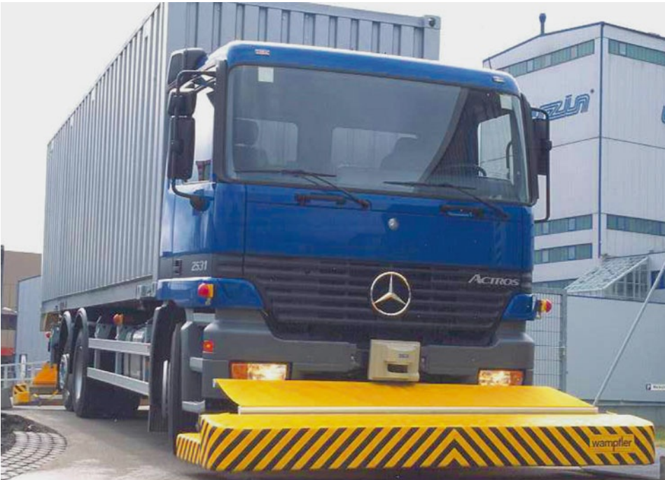
Abb. 1.32 Innerbetrieblicher fahrerloser Transport mit automatischem Materialumschlag mit dreiaxsigem Mercedes-Benz Actros (Daimler AG)
