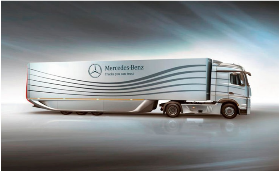
Abb. 1.7 Designstudie Aerotrailer spart im Jahr ca. 2000 Liter Dieselmotorkraftstoff und mehr als 5 t CO 2 (Daimler AG)
