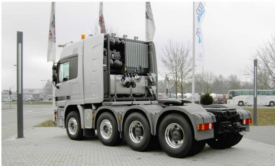
Abb. 1.5 Schwerlastzugmaschine Actros-SLT (8×4/4) mit V8-Motor mit 480 kW. Zusatzkühlanlage hinter dem Fahrerhaus (E. Hoepke)
