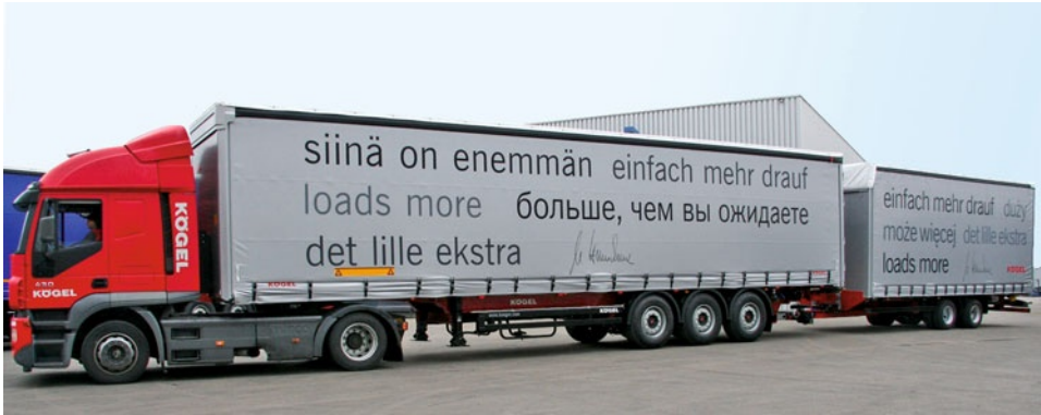
Abb. 1.6 Volumenzug „long truck“ von Kögel mit einer Länge von 25,25 m. Zunächst als Praxisversuch mit 40 t Gesamtgewicht zugelassen (Kögel)
