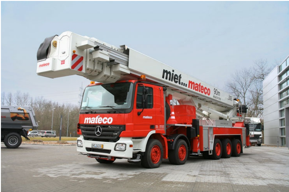
Abb. 1.3 Fünfachsiges Fahrwerk mit 5. Achse als gelenkte Nachlaufachse für Sonderaufbauten (Daimler AG)
