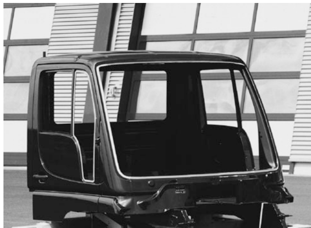
Abb. 1.30 Fahrerhaus des kleinen Unimog aus Kohlefaser-Verbundwerkstoff (aus: F+K 1/2000)
