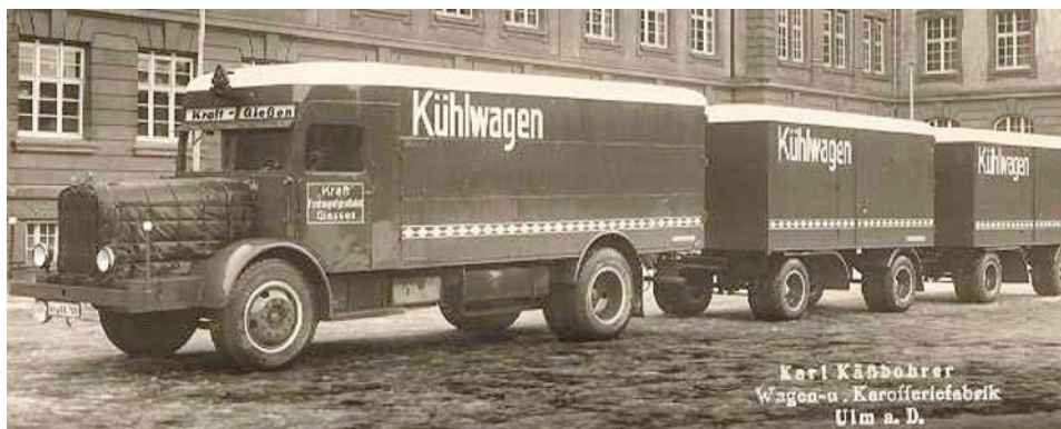
Abb. 1.4 Untermotorisierter Lastzug 1936 von Henschel/Kässbohrer mit 125-PS-Dieselmotor, 34 t Gesamtgewicht (3,7 PS/t) (Karl Kässbohrer GmbH)
