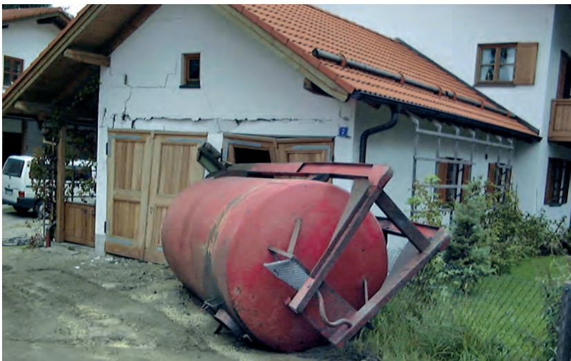
Abbildung 1: Folge von mangelnder Ladungssicherung
