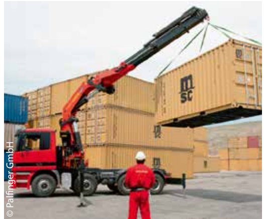
■ Abb. 1.1 Ladekran im Einsatz
