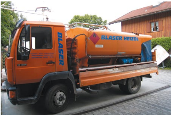
■ Abb. 3.2 Trägerfahrzeug mit Aufsetztank
