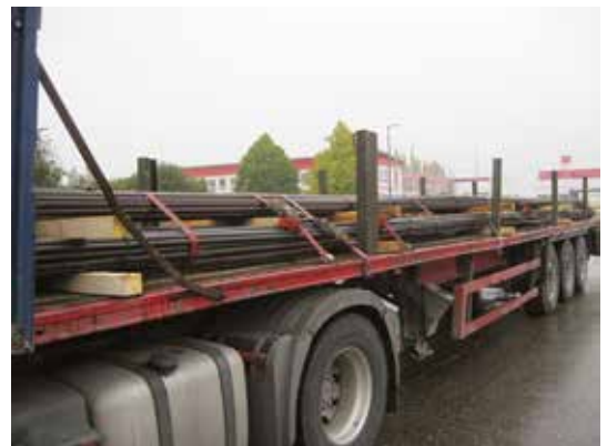
■ Abb. 6.75 Sicherung von Betonstahlbunden, Quelle: Hassold
