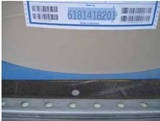
■ Abb. 6.71 Sicherung mit Antirutschmatten, Quelle: Palm
