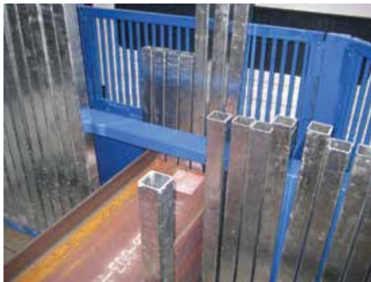
■ Abb. 6.72 Absteckbare Rungen können an die Ladebreite angepasst werden, Quelle: Bieber
