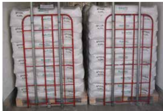
■ Abb. 6.16 Heckabschluss durch Sperrstangen, Quelle: Rudolf Sander
