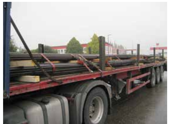
■ Abb. 6.75 Sicherung von Betonstahlbunden, Quelle: Hassold
