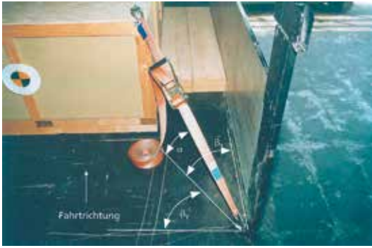
■ Abb. 6.22 Die Winkel \alpha , \beta_x und \beta_y
