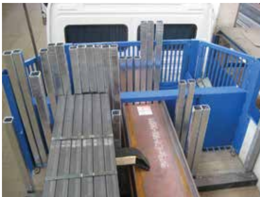
■ Abb. 6.73 Die Auflageflächen der Verladehölzer sind mit stabilen rutschhemmenden Matten verklebt, Quelle: Bieber
