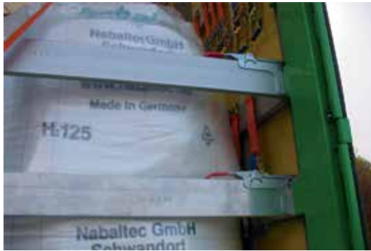
■ Abb. 6.17 Heckabschluss durch zwei Klemmbretter, Quelle: Rudolf Sander
