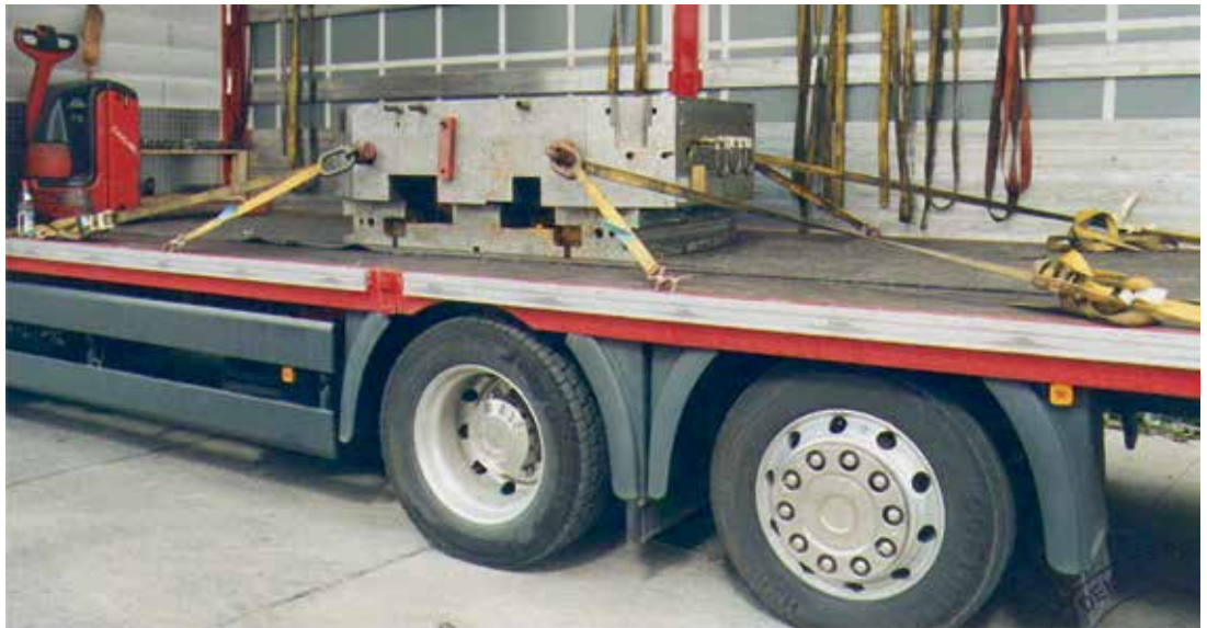
■ Abb. 6.24 Sonderfall: Diagonalzurren unter Verwendung von zwei Zurrpunkten für ein Zurrmittel, Quelle: Rudolf Sander
