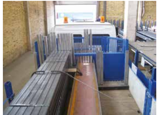
■ Abb. 6.74 Einzelne Ladungen könne zusätzlich durch Niederzurren gesichert werden, Quelle: Bieber
