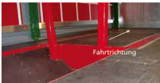
■ Abb. 6.14 Formschluss nach vorne durch Mulde und Vierkantröhre (für Stahlcoils), Quelle: Rudolf Sander
