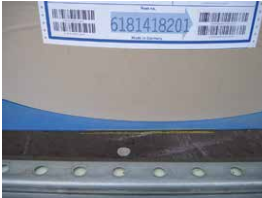
■ Abb. 6.71 Sicherung mit Antirutschmatten, Quelle: Palm
