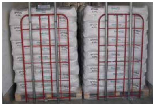
■ Abb. 6.16 Heckabschluss durch Sperrstangen, Quelle: Rudolf Sander
