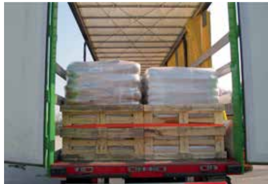
■ Abb. 6.15 Heckabschluss durch Kopfbucht und Paletten, Quelle: Rudolf Sander
