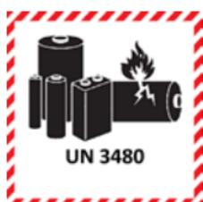
Das Kennzeichen für die „kleinen Lithiumbatterien“ ist erforderlich bei Versandstücken mit Lithiumzellen und -batterien, die nach der Sondervorschrift SV 188 befördert werden.
