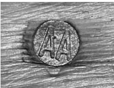
Abb. 4: Nagelkopfkennzeichnung<sup>1</sup>
