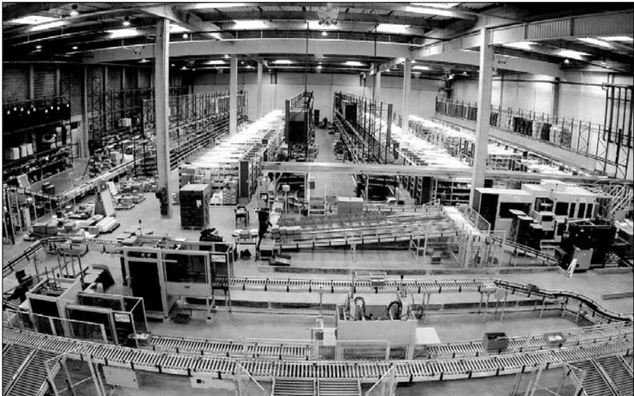
Abb. 1: Kommissioniersystem nach dem Pick-&-Pack-Prinzip
