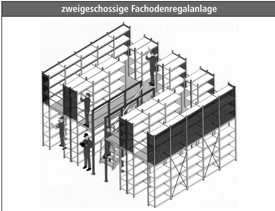
Abb. 9: zweigeschossige Fachbodenregalanlage
