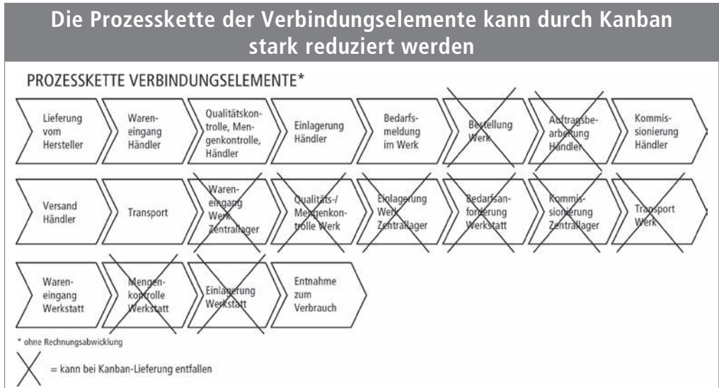
Abb. 3: Reduzierung der Prozesskette durch Kanban
