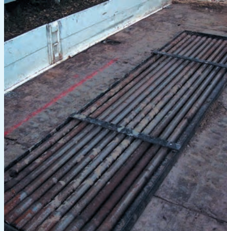
Ladungssicherung von Bohrgestänge auf einem Anhänger. Diese Gestänge sind sicher untergebracht und zur Anbringung / Entfernung der Sicherung genügt ein Handgriff.
