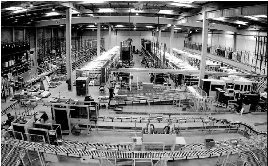
Abb. 1: Kommissioniersystem nach dem Pick-&-Pack-Prinzip
